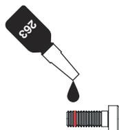
締め付けはデジタルトルクレンチを使用して表の通り3回に分けて8Nmで行ってください。
