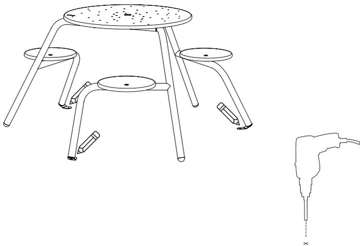
5. 地面にアンカーを打ちます。アンカーにビスを入れて固定します。
