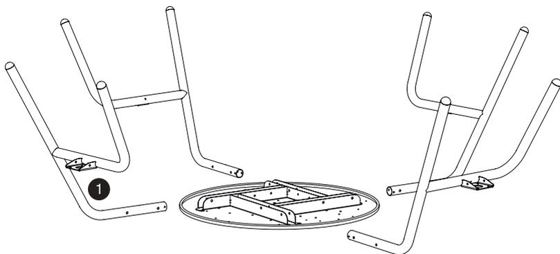
3. 図のように外側からボルト(M8x60)を差し込み、ワッシャー(M8)とナット(M8)で締めます。
